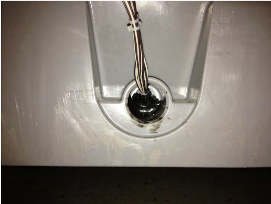
Figur 2.3 Tätning av kabelgenomföringar för termoelement med tätningsmassa av butyl.
