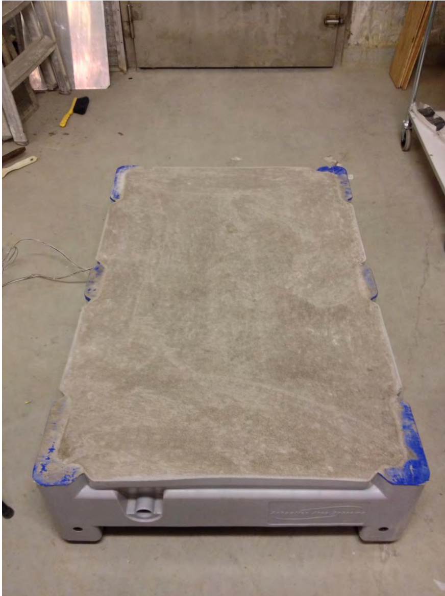
Figur 2.7 Betongplatta efter 1 dygns härdning i 20°C då betongens övre yta exponerats för 95 % RF.
