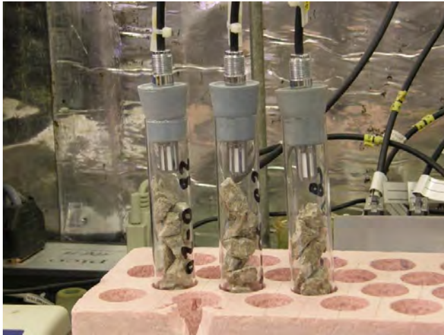
Figur 2.15 Mätning av relativ fuktighet på uttagna prov placerade i provrör med givare av fabrikat Vaisala HMP44.
