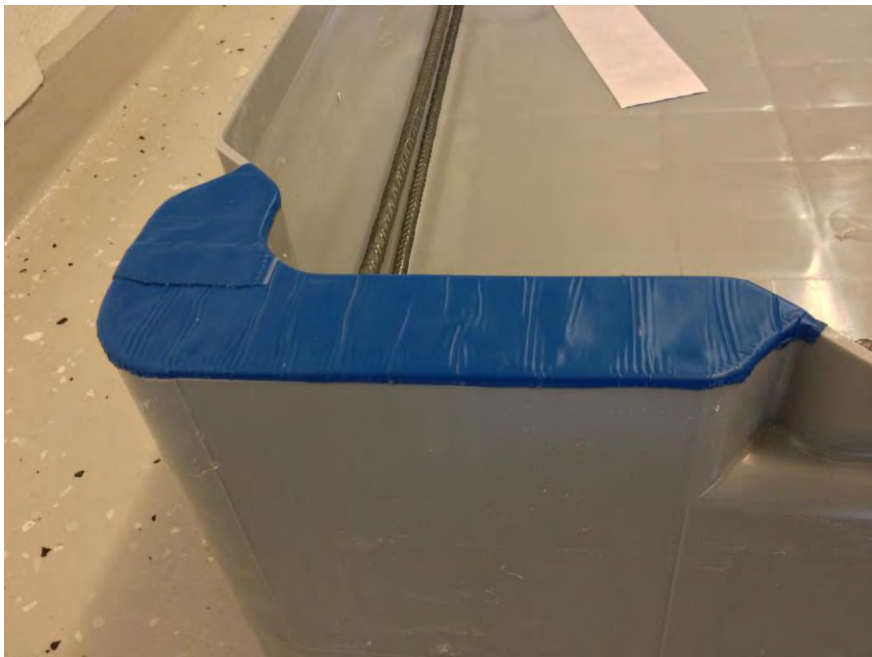
Figur 2.2 Gjutformens förstyvningsprofiler förseglades med butyltejp före gjutning för att underlätta försegling av formen, se Figur 2.8.
