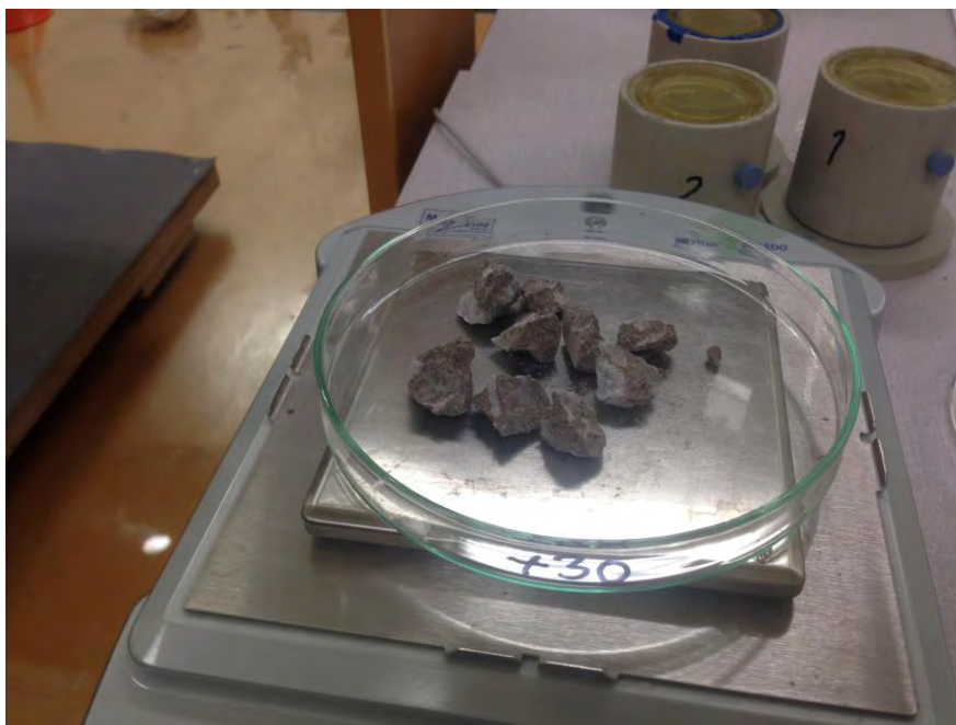
Figur 2.16 Uttagna provbitar placerade på våg för registrering av fuktavgång som funktion av tid och provbitarnas initiala temperatur.
