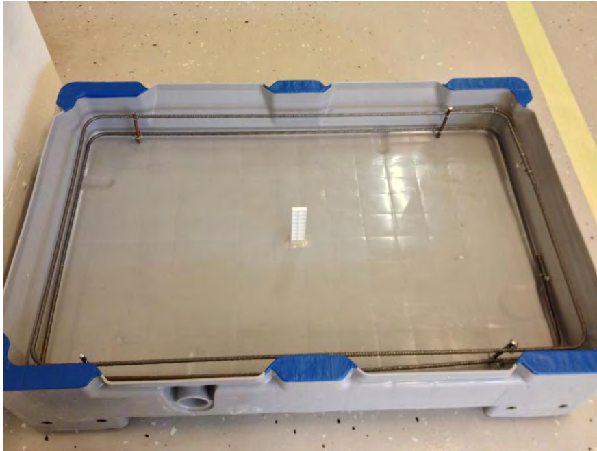
Figur 2.1 Gjutform för plattor med bottenyta 800 \times 1200 \text{ mm}^2 och höjden 150 mm. Kantarmering för ingjutning placerades i formen samt hållare i vit plast för placering av termoelement för temperaturmätning på olika djup.
