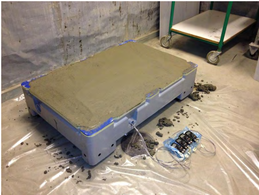
Figur 2.6 Betongplattans yta stålglättades efter gjutning för att den skulle bli så jämn som möjligt. Datorloggrar kopplade till termoelement för registrering av betongens temperatur under härdningsförloppet.
