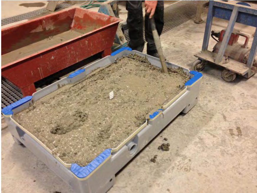
Figur 2.5 Gjutning med trögflytande konsistens i två skikt med mellanliggande bearbetning med stavvibrator.
